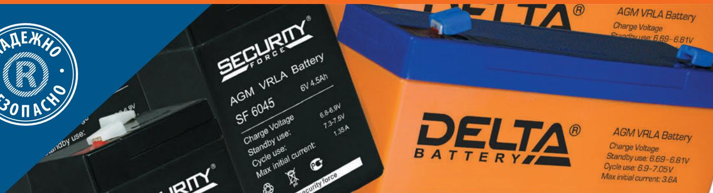
Герметизированные свинцово-кислотные аккумуляторные батареи с VRLA (Valve Regulated Lead Acid) клапаном изготавливаются по технологии AGM (Absorbent Glass Mat — электролит, абсорбированный в стекловолоконном сепараторе). Такие аккумуляторы не требуют обслуживания, долива дистиллированной воды и характеризуются низким саморазрядом.
